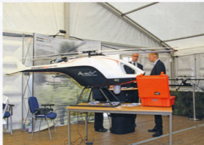
Gleich neben dem Zeiteingang steht eine Drohne mit ineinanderkämmernden Flettner-Rotoren, die bereits beim ersten RotorDrone-Forum 2015 dabei war. Die Firma AvooX GmbH (ehemals PowerVision) aus Runkel-Einrich hat die mächtige Flettner-Drohne, mit der Bezeichnung Dragonfly DF T20, mitgebracht. Stütze 2x 2.450 mm-Rotordurchmesser werden von der 6 kW leistenden Turbine in Drehung versetzt. Mehr unter: www.AvooX.de
