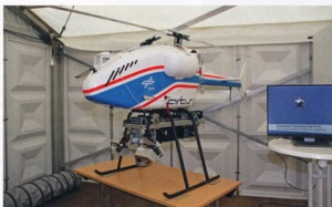
Der Stand der DLR aus Braunschweig, betreut vom freundlichen Jörg Dittlich, zeigt eine zweite Turbinen-getriebene, riesige Drohne mit ihren beiden Flettner-Rotoren. Diese ist voll bestückt mit Kamera, Messinstrumenten und Sensoren für die unterschiedlichsten Forschungsziele der DLR.
